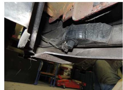
Dans les passages de roue AR, démontez les 3 vis de fixation du passage de roue au pare choc, et démontez la vis de fixation du pare choc à la caisse
