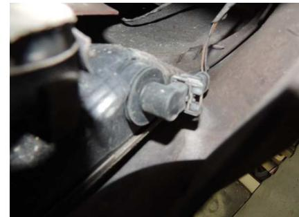
A l'intérieur du pare chocs AR, coté roue ARD, débrancher la fiche électrique du feu de recul.
