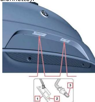
A l'intérieur du pare chocs AR, coté roue ARG, débrancher la fiche électrique du feu de brouillard AR.
